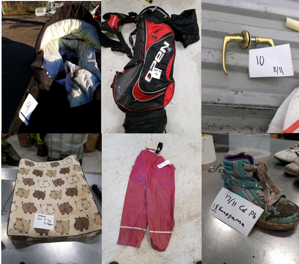
Figur 33: Exempel på produkter som innehöll grundämnen över valda halter. Barnvagnen innehöll brom, golfväskan innehöll bly och dörrhandtaget innehöll kadmium. Skötbordet innehöll nickel, regnbyxorna innehöll bly och nickel. Regnbyxorna innehöll även klor, men i lägre halt än det som satts som gräns för PVC-innehåll. Knapparna på skorna innehöll bly, kadmium och nickel.
