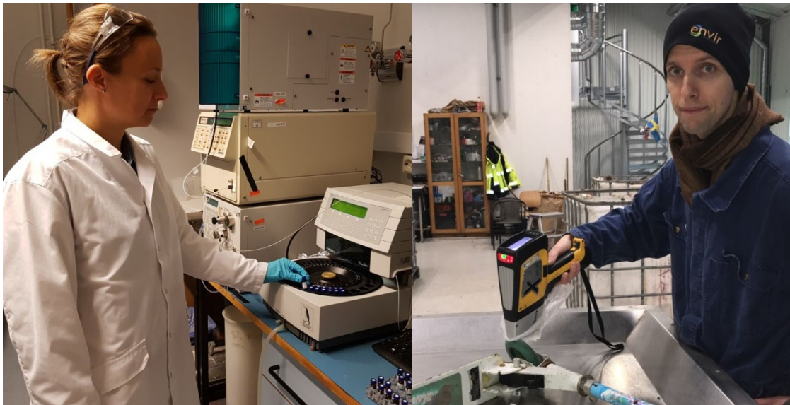
Figur 2. Analys med vätskekromatograf på laboratorium och med XRF-skanner i fält. Vi använde olika instrumenten och metoderna för att leta efter olika ämnen.
