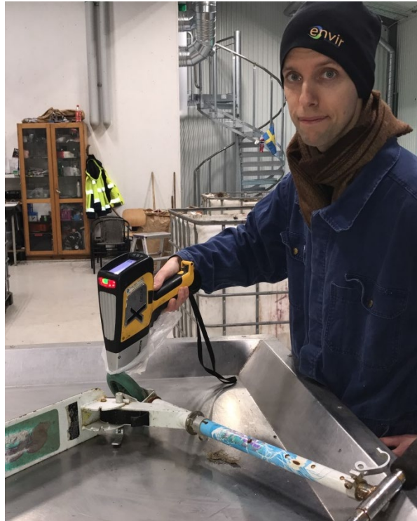
Figur 41. XRF-skannern är en tung batteridrivna apparat som mäter ett urval grundämnen i översta millimetrarna av olika produkter.
