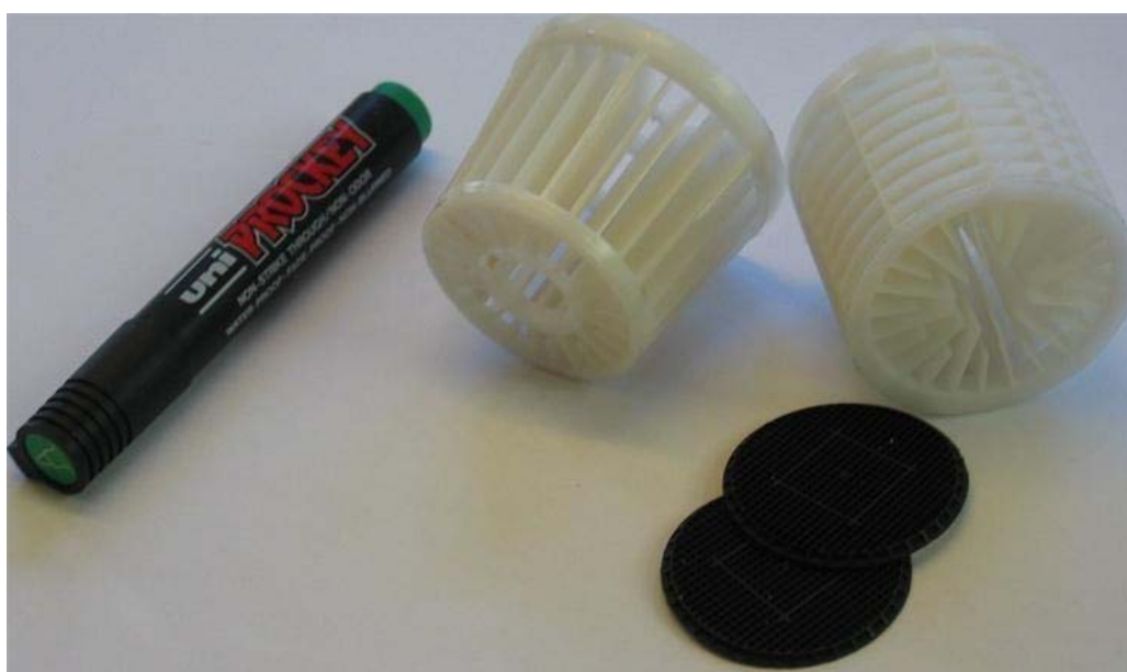
Figur 12. Bärmaterial för nitrifikation (nederst) och denitrifikation (överst).
