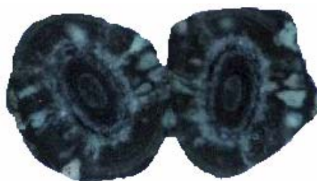
Figur 2. Granuler i genomskärning ( www.uasb.org ).
