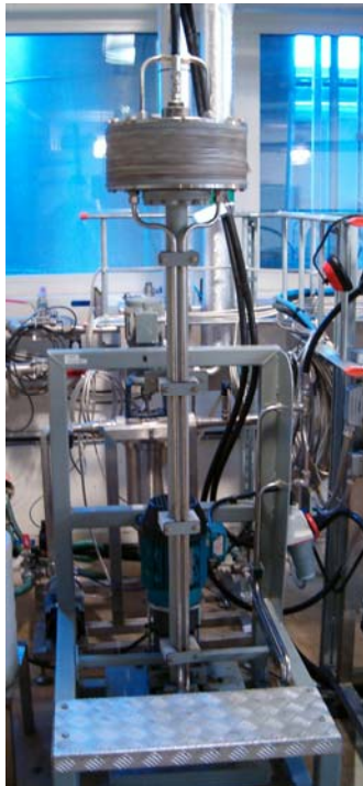
Figur 2.1. Plattmembranerna sitter monterade i stapel i övre delen på en axel. (Foto: Carlsson, 2005)
