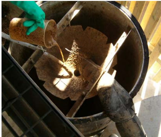
Figur 5.1. Matavfall hålls i reaktorn via en tratt. Även slangarna för svartvatten och recirkulerat permeat syns i figuren.
