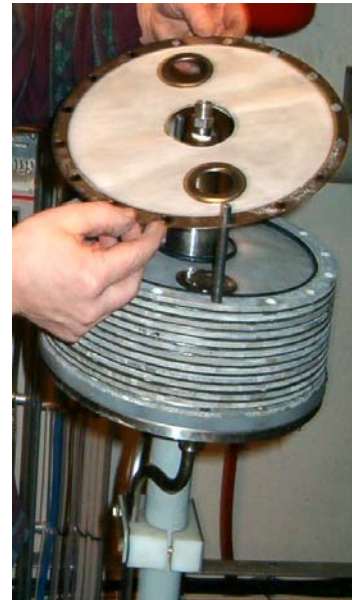
Figur 4.3. Plattmembranen sitter monterade ovanpå varandra i stapel. (Foto: Carlsson, 2005)
